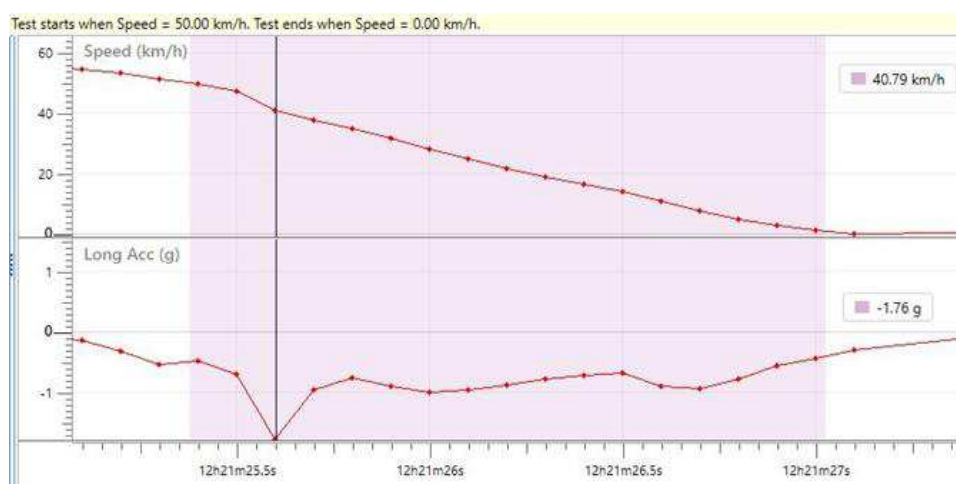
Obrázek 7 Detail vyhodnocení šestého testu brzdění soupravy DA s vozíkem z v_0 = 50 \text{ km}\cdot\text{h}^{-1}
