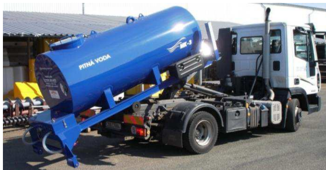
Obrázek 1 Kontejnerová cisterna na pitnou vodu ( https://www.kobit.cz/produkty-nastavba-na-pitnou-vodu-mk-3-detail-125 )
