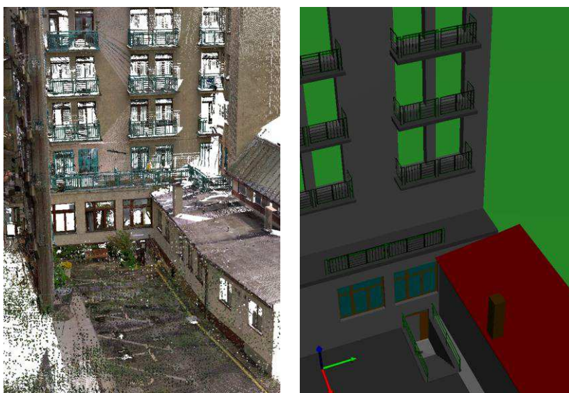
Obrázok 1 Pohľad na mračno bodov exportované z prístroja Faro FocusS 350 (vľavo) a na vytvorený 3D CAD model (vpravo) predmetnej časti hotela
