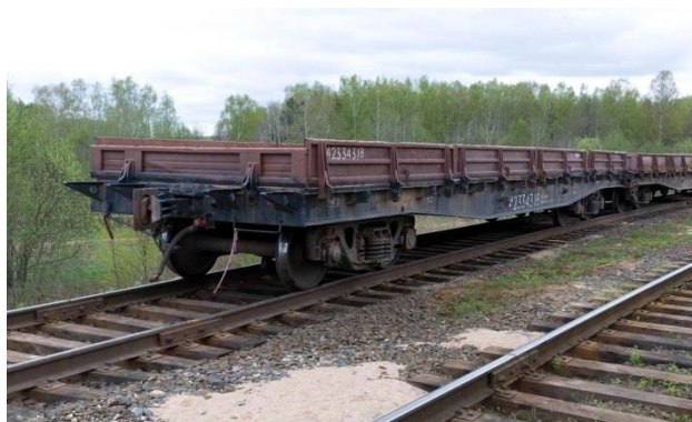
Obr. 4. Plošinový vozeň, model 13-401
