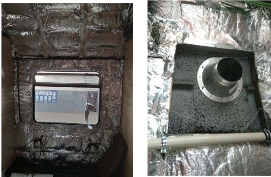
Obr. 3 Ukážka umiestňovania izolácie vo vozni Fig. 3 Example of insulation placement in a wagon
