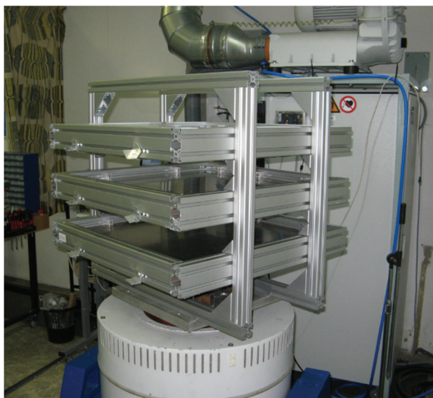
Obr. 4 Skúšobný stojan na skúšky životnosti izolácií (1 typ izolácie 3 vzorky)
