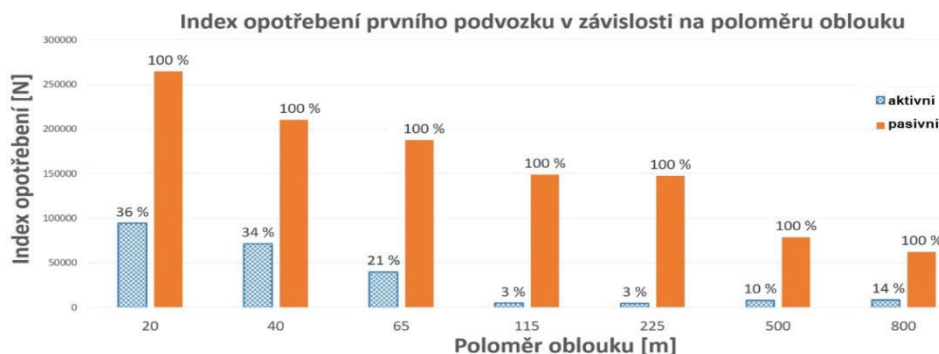
Obr. 4 Index opotřebení v kontaktech kola a kolejnice na prvním podvozku za různých okrajových podmínek
