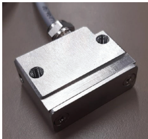
Obr. 3 Sn ima e ACC-S um st en e na stojin e kolejnice (v yrobce STARMON s.r.o.)
