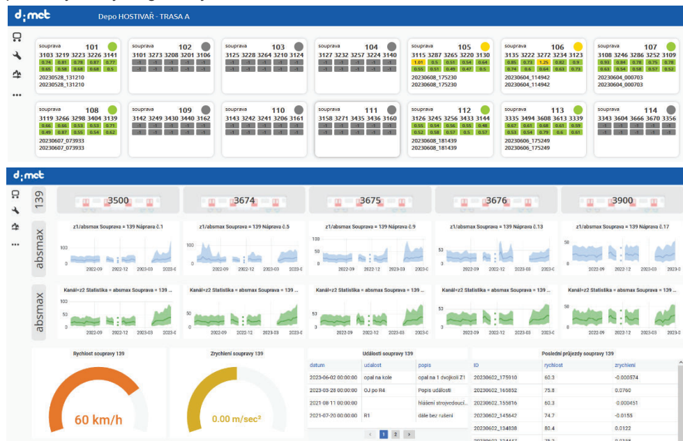
Obr. 4 Ukázka webového rozhraní pro vizualizaci výsledků. Pohled na obrazovku „depot“ s přehledem stavu souprav (nahore) a pohled na detail „souprava“ (dole).
