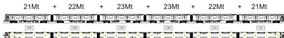
Obr. 2 Uspořádání vozů soupravy metra pro město Varšava
