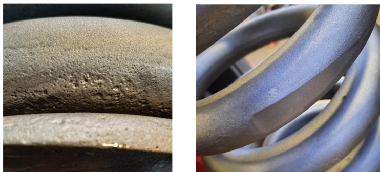
Obr. 7 Povrchov e vady po odstran en i povrchov e ochrany
