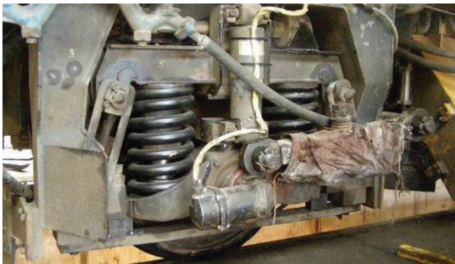
Obr. 9 Zamontované renovované pružiny na koľajov m pluhu KP900
