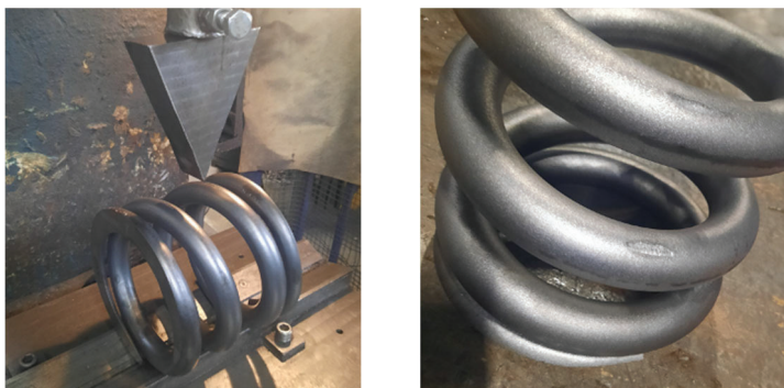
Obr. 8 Rovnání pružin nalevo, stopy po klínu napravo
