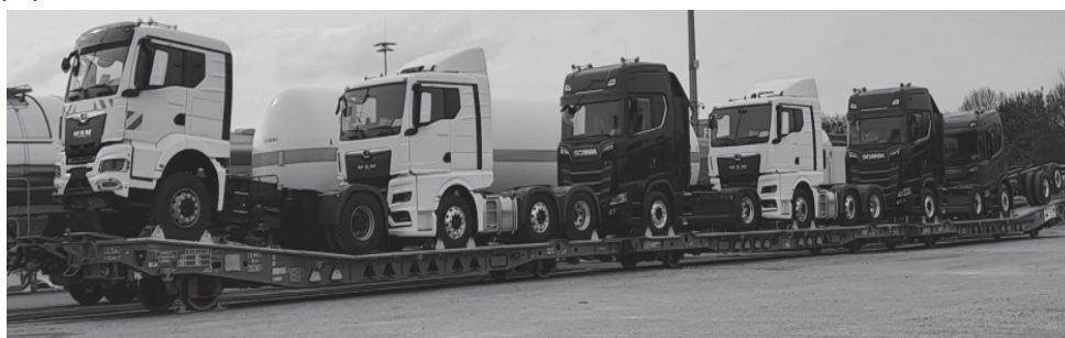
Obr. 6 Vozeň na prepravu ťahačov a ľahkých úžitkových vozidiel Fig. 6 Wagon for transportation of truck tractors and light utility vehicles
