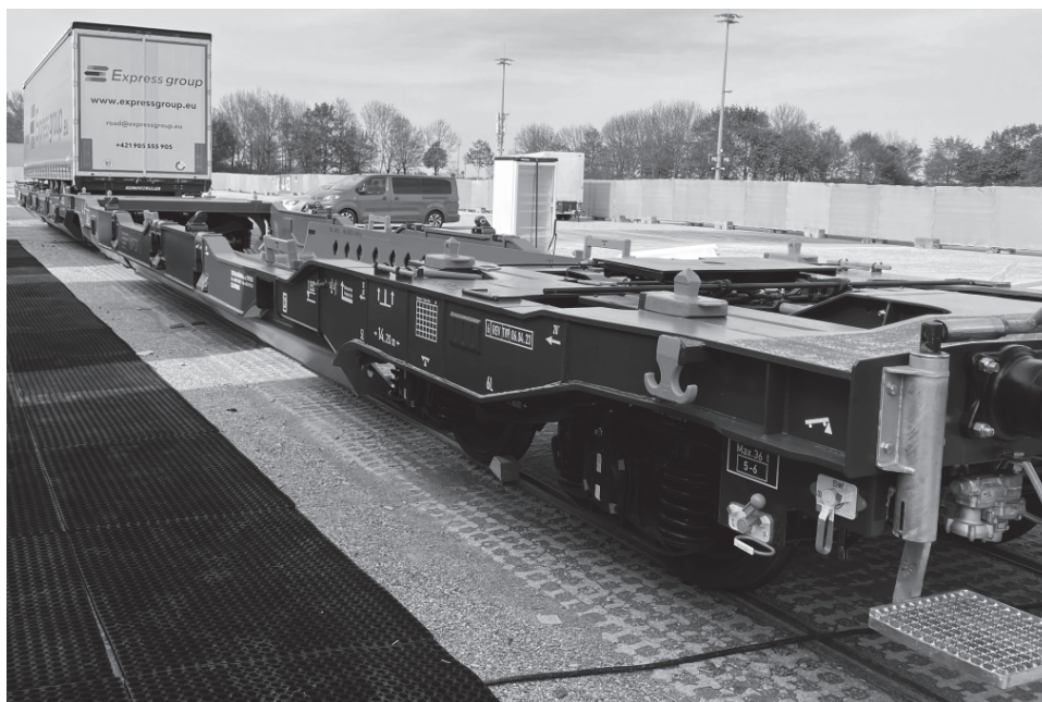
Obr. 5 Košový vozeň Sdggmrss na prepravu návesov a kontajnerov Fig. 5 Basket wagon Sdggmrss for transport of trailers and container
