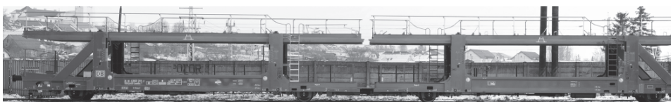
Obr. 7 Vozeň na prepravu osobných automobilov, SUV, malých úžitkových vozidiel
