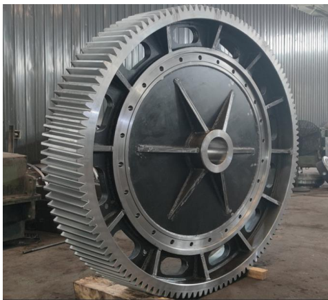
Obr. 2. Zvárané teleso čelného ozubeného kolesa
