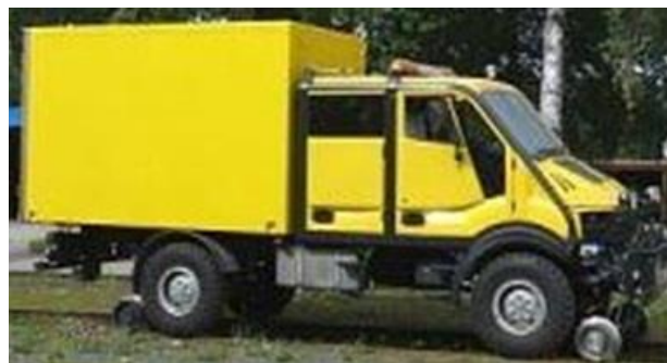
Obr. 1. Dvojcestné vozidlo FriLiner s prenos síl typu guma-koľajnica
