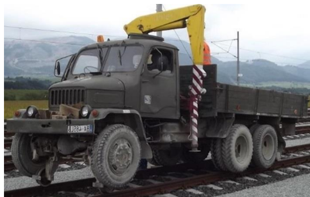
Obr. 2. Prenos síl typu guma-koľajnica na staršom nákladnom vozidle Praga V3S
