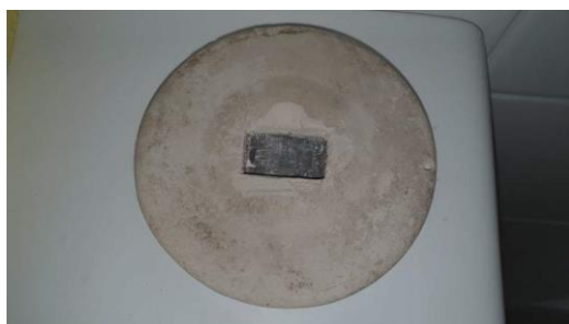
Obrázok 2: vzhľad vzoriek v epoxidovej živici s TBC
