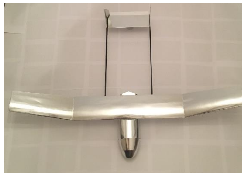
Obrázok 2: Finálna verzia UAV bez elektroniky [Zdroj: autor]
