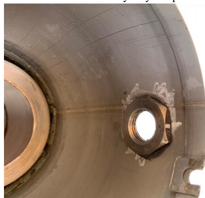
Obrázok 42: Uloženie matice v plášti motora [Zdroj: autor]
