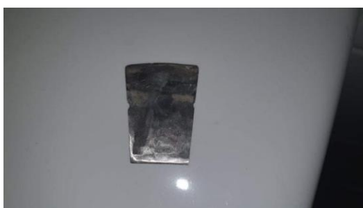
Obrázok 4: vzhľad testovaného materiálu bez TBC
