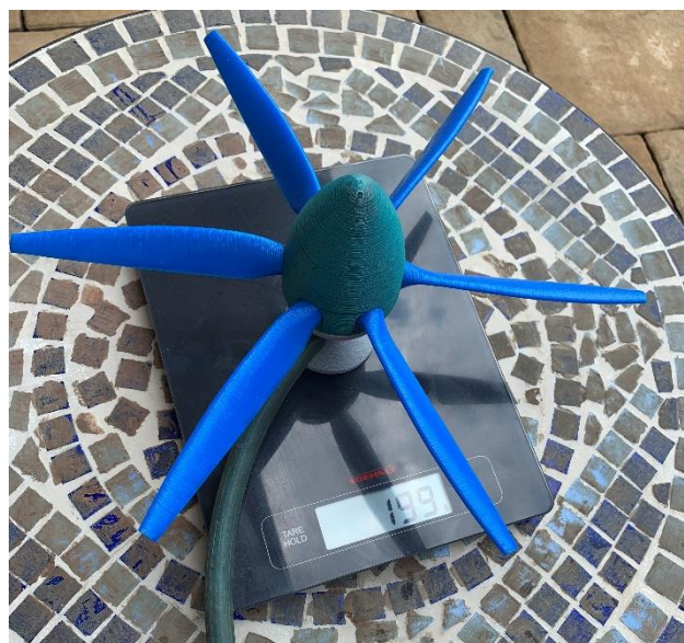
Obrázok 13: Experiment pre výpočet ťahu [zdroj: autor]
