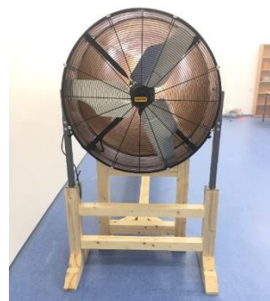
Obrázok 22: Pohonná jednotka (ventilátor) aerodynamického tunela [zdroj: autor]
