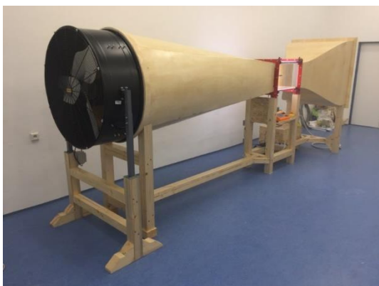
Obrázok 24: Aerodynamický tunel po konečných úpravách [zdroj: autor]
