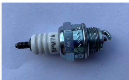
Obrázok 38: Zapaľovacia sviečka NKG BPM7A [Zdroj: autor]
