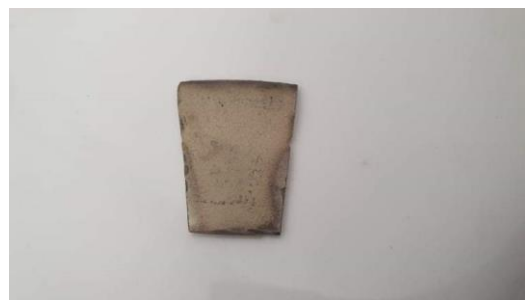
Obrázok 5: vzhľad testovaného materiálu s TBC
