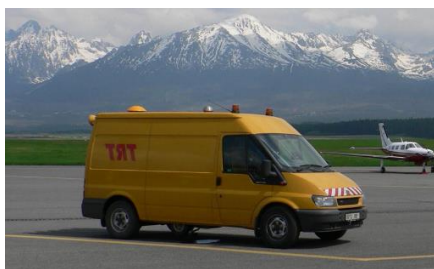
Obrázok 4: Vozidlo vybavené systémom TRT (TATRA Friction Tester Vehicle) [19]
