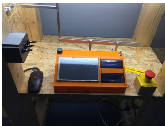
Obrázok 23: Programovateľný mikropočítač Arduino na snímanie dát zo senzorov [zdroj: autor]
