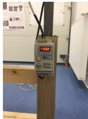
Obrázok 17: Frekvenčný menič na reguláciu otáčok ventilátora [zdroj: autor]
