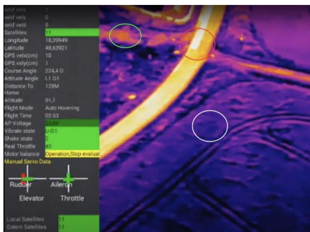
Obrázok 4: Rôzne typy povrchu a ich vplyv na infračervenú snímku [11]
