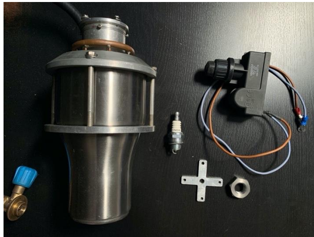
Obrázok 37: Motor a súčiastky spúšťacej sústavy [Zdroj: autor]
