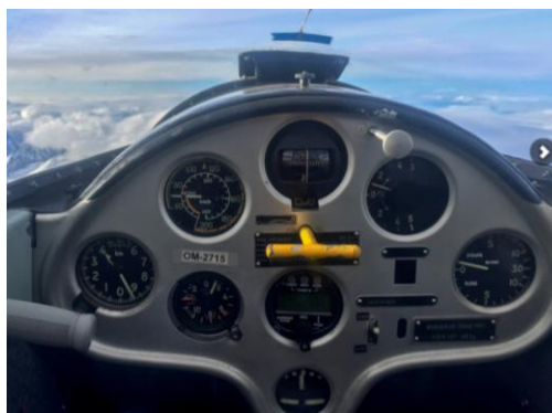
Obrázok 3 - Prístroje vetrona Blaník L-13 [Zdroj: http://www.aeroklubpoprad.sk/node/445 ]
