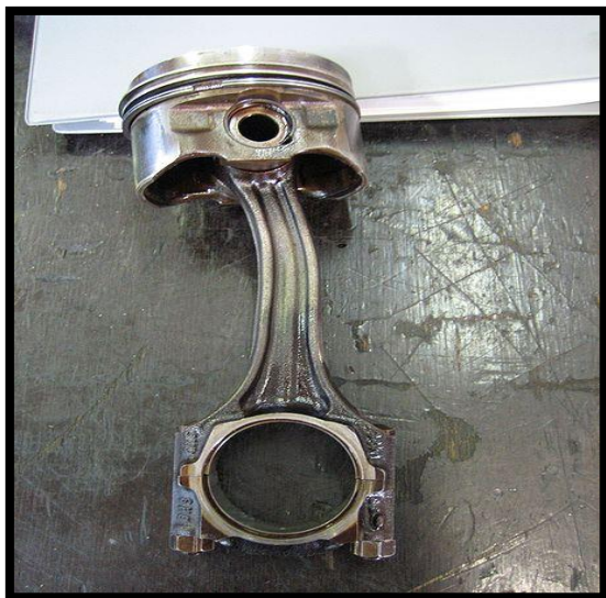
Obrázok 4: Ojnica ohnutá pod vplyvom vysokého tlaku v nekovanom motore [4]
