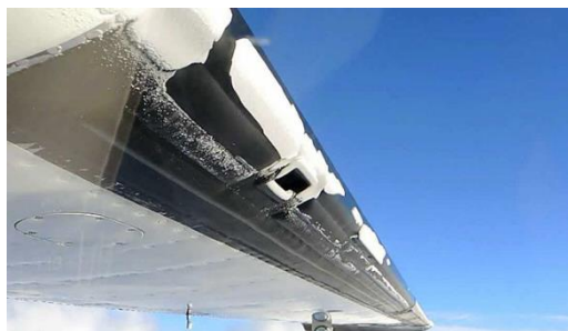
Obrázok 1: Nafukovacia nábežná hrana [Zdroj: https://www.boldmethod.com/learn-to-fly/systems/how-deicing-boots-work/ ]
