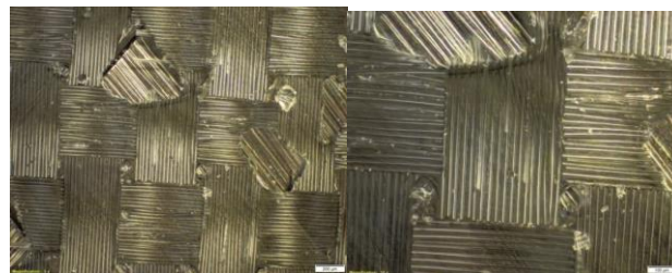
Rys. 5. Mikrostruktura laminatu kompozytowego ze zbrojeniem tkaniną biaksialną IMS65 CTLX
