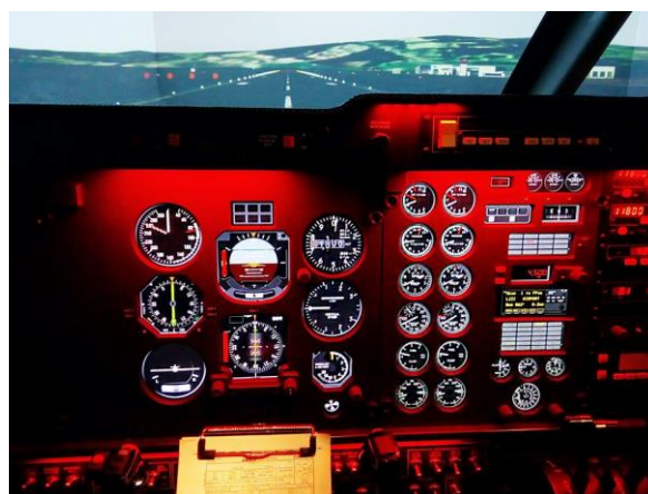
Obrázok 10: Letový simulátor ELITE S923 FNPT II MCC. Zdroj: Autori.
