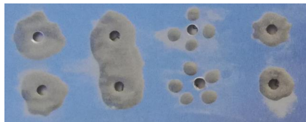
Obrázok 5: Hliníkový prášok nalepený na povrch plechu. Zdroj: Autori.
