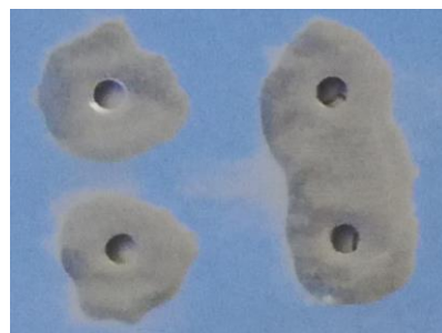
Obrázok 10: Hliníkový prášok skenovaný v druhej vrstve nitovanej vzorky (fotografia pred znitovaním plechov). Zdroj: Autori.
