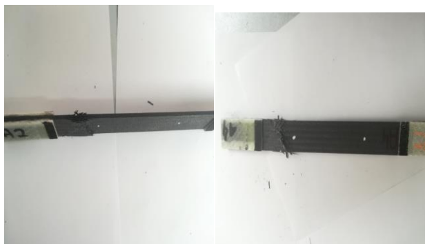
Rys. 3. Wygląd próbek z serii A po badaniach stanowiskowych na rozciąganie
