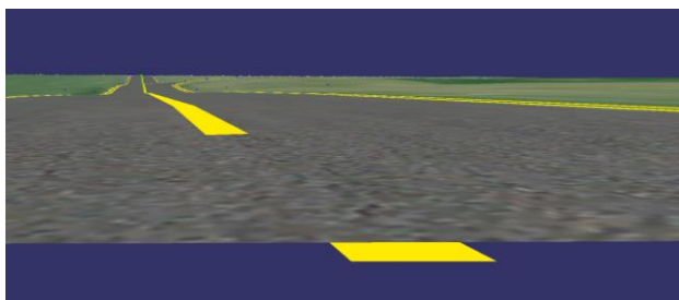
Obrázok 4: Nedostatočný počet vertexov stredovej čiary na komplexnom teréne (Zdroj: Autor)
