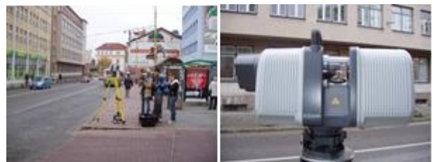
Obrázok 4: Pohľady na prístroj Trimble CX pri meraní rovnosti povrchu vozovky zastávky MHD Hurbanova v Žiline. Zdroj: (Decký a kol., 2018).
