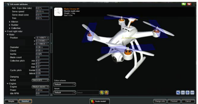
Obrázok 2 Letový simulátor UAS- PHOENIX RC (V5.5) – úprava parametrov UA. Zdroj: Autori.
