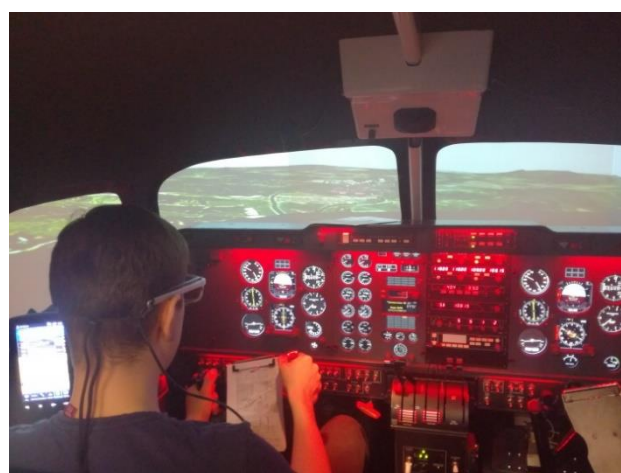
Obrázok 2: Meranie presnosti pilotáže počas ILS priblíženia na simulátore ELITE S923 (Zdroj: Autori).
