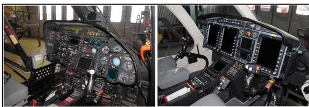
Obrázok 3: Porovnanie kabíny pilota A109K2 a Bell429. Zdroj: https://www.airliners.sk/wp-content/uploads/2017/11/Porovnanie-Agusta-Bell.jpg
