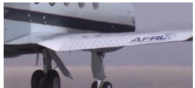
Obrázok 5: FlexFoil na pravom krídle Gulfstream III. Zdroj: [15].
