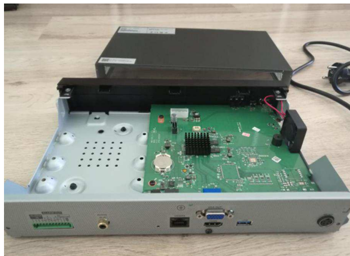
Obrázok 2 Rozobraté QRN-410 pripravené na inštaláciu disku
