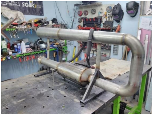
Obrázok 72: Konštrukcia bezventilového pulzného motora. Zdroj: Autori.
