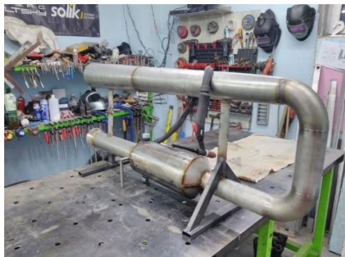
Obrázok 72: Konštrukcia bezventilového pulzného motora. Zdroj: Autori.
