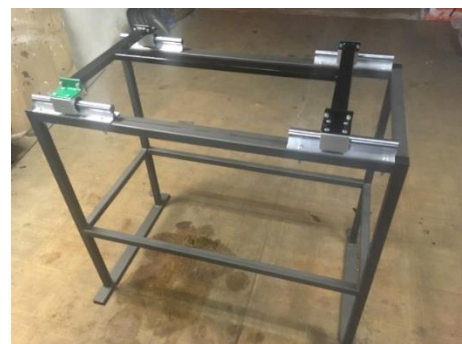
Obrázok 71: Konštrukcia kovového stacionárneho podstavca. Zdroj: Autori.
