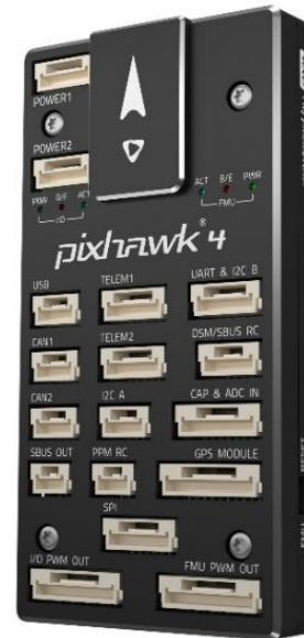
Obrázok 21: Riadiaca jednotka autopilota Pixhawk 4. Zdroj: [13].
