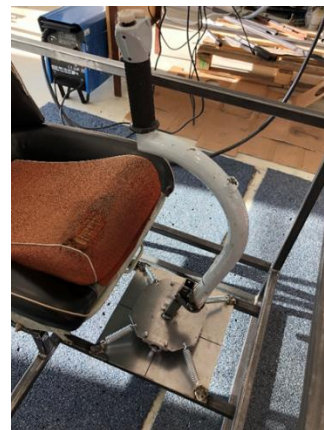
Obrázok 3: Pohyblivý mechanizmus riadiacej páky. Zdroj: Autori.
