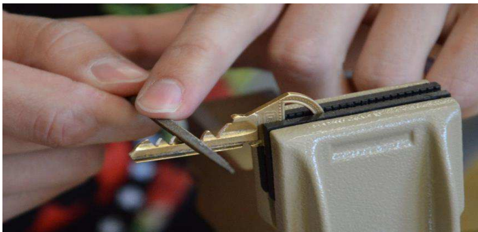
Obrázok 3 Výroba univerzálneho kľúča pre SG metódu (Mach, 2016)
