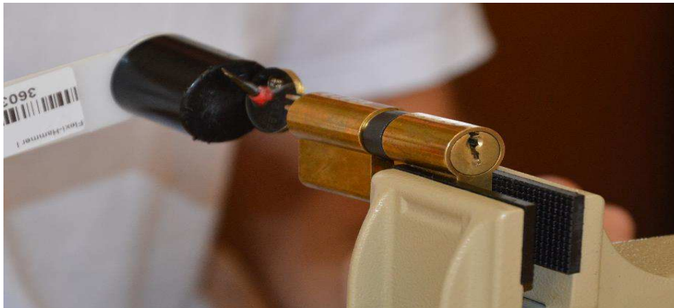
Obrázok 4 Použitie univerzálneho kľúča pre S - G (Bumping) metódu (Mach, 2016)
