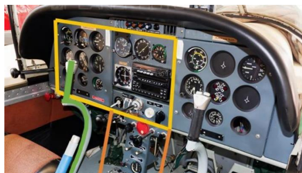
Obrázok 1: Rozloženie prístrojov letúna Zlín Z 142; časti označené farbou: zelená, žltá a oranžová použijeme v simulátore podľa potreby. Zdroj: Autori.
