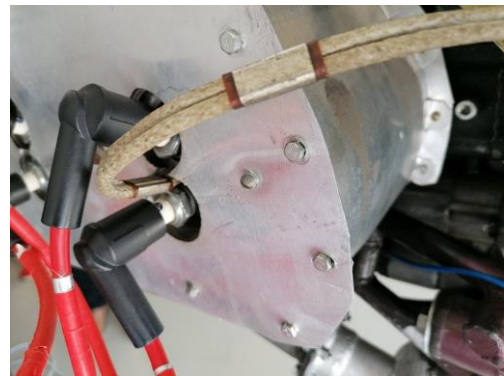
Obrázok 11: Zapojenie termoelektrického snímača. [Zdroj: autori]
