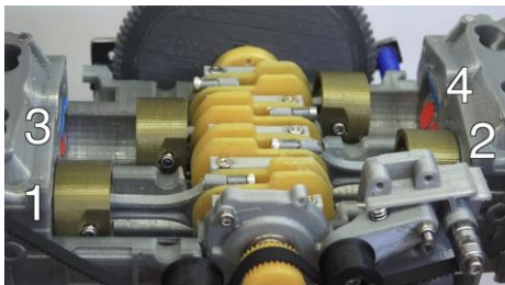
Obrázok 2: Znázornenie poradia zapálenia zmesi v motore typu boxer. [Zdroj: https://www.autoforum.cz/technika/jak-funguje-motor-typu-boxer-funkcni-model-z-3d-tiskarny-vam-to-ukaze-zevnitř/ ]
