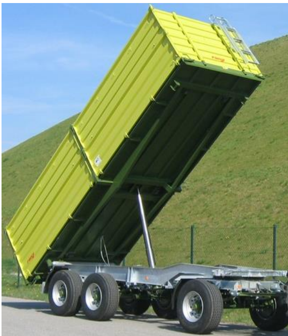
Obr. 7. Trojstranný sklápací príves sklopený dozadu[7]
