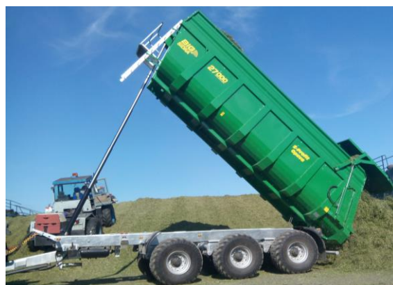
Obr. 4. Jednostranný sklápací návěs s predným piestom [5]
