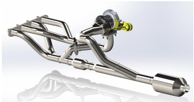
Obr. 9. Celkový návrh výfukového potrubia
