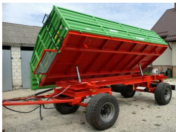
Obr. 5. Dvojstranný sklápací príves [6]
