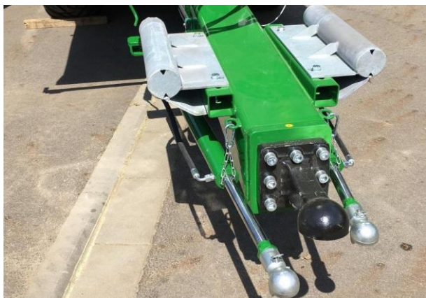
Obr. 6. Ovládacie tyče pre nútené riadenie nápravy prívesu za traktor [2]
