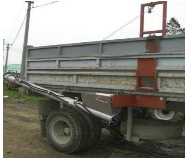
Obr. 3. Príves spoločnosti BBS vybavený bočným dopravníkom na prekladanie krmných zmesí [3]
