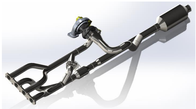
Obr. 10. Celkový návrh výfukového potrubia
