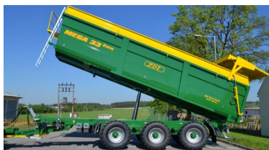
Obr. 3. Jednostranný sklápací návěs so spodným piestom [4]
