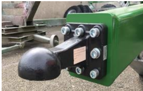
Obr. 8. Ťažná hlava prívesu
