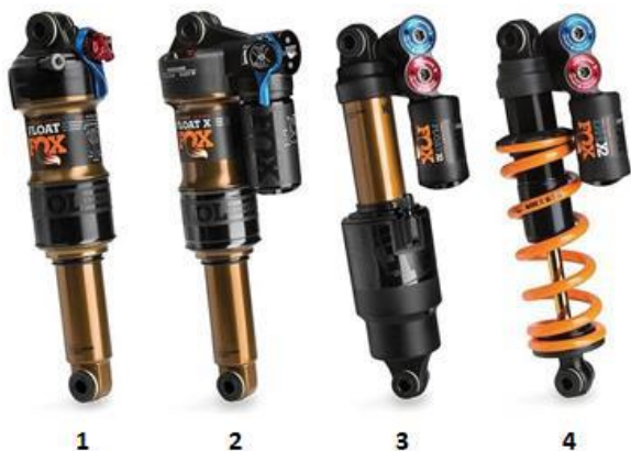
Рис. 1. Типы задних амортизаторов: 1 - воздушный без расширительного бака, 2, 3 - воздушный с расширительным бачком, 4 - пружинный [5]
