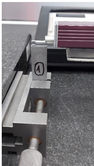
Obr. 7. Meranie drsnosti plochy vzorky po integrovanom strihaní
