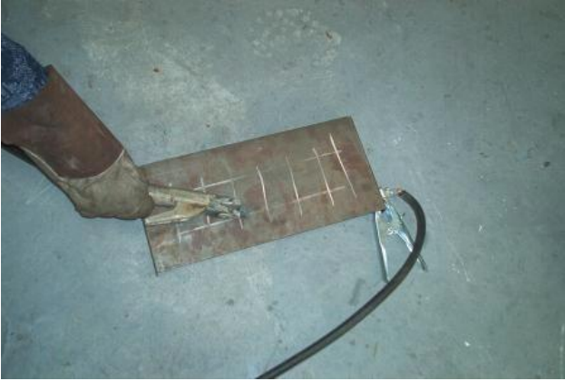
Obr. 8. Postup vykonania rovnania bodovým ohrevom
