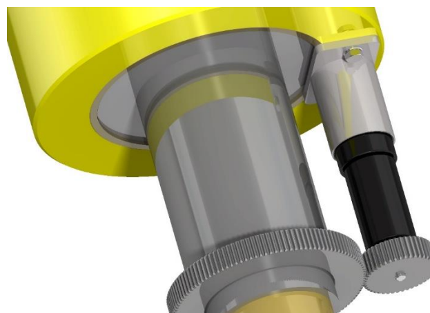
Obr. 5. 3D CAD model mechanizmu otáčania výložníka
