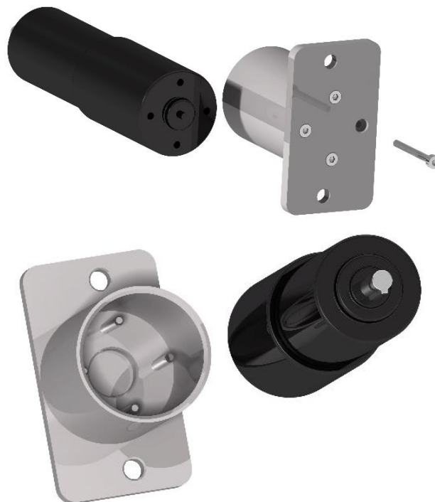
Obr. 4. Rôzne pohľady na uchytenie elektromotora do držiaka
