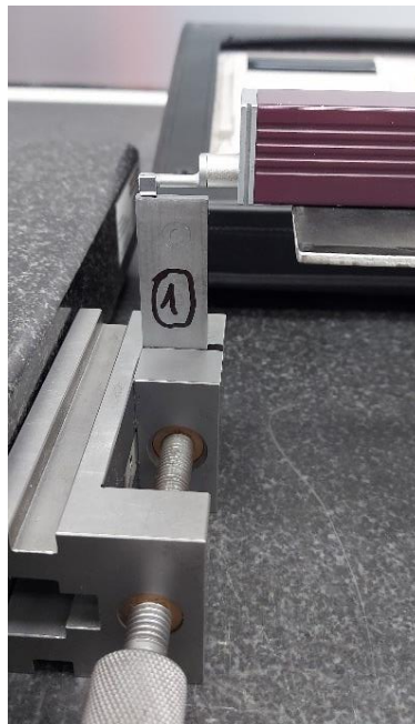
Obr. 7. Meranie drsnosti plochy vzorky po integrovanom strihaní
