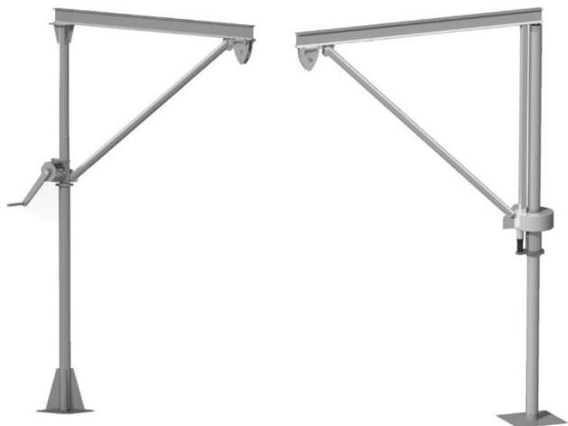
Obr. 1. 3D CAD model pôvodného závesu (vľavo) a po úprave s elektrickým otáčaním (vpravo)
