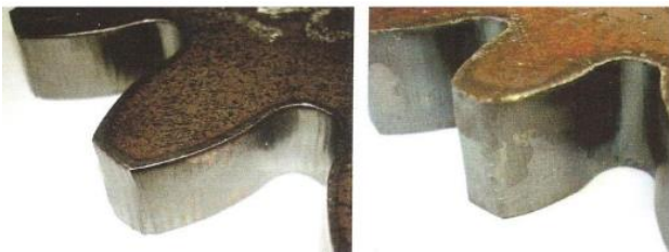
Obr. 3. Časť ozubenia vyrobená plazmovým lúčom pri rôznej hrúbke ozubenia
