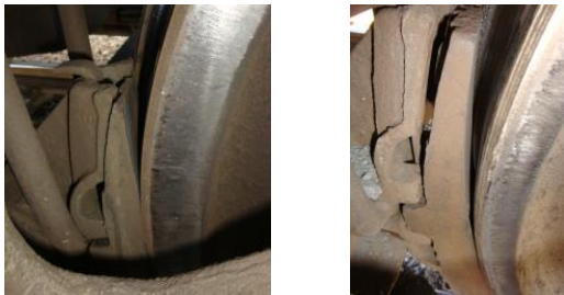
Obr. 1. Klinovité opotrebované brzdové klátiky vozňov
