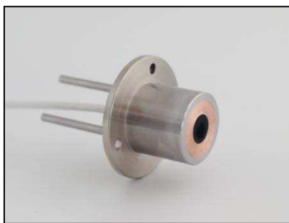
Obr. 2 Vodou chladený snímač tepelného toku SCHMIDT-BOELTER SBG01-100
