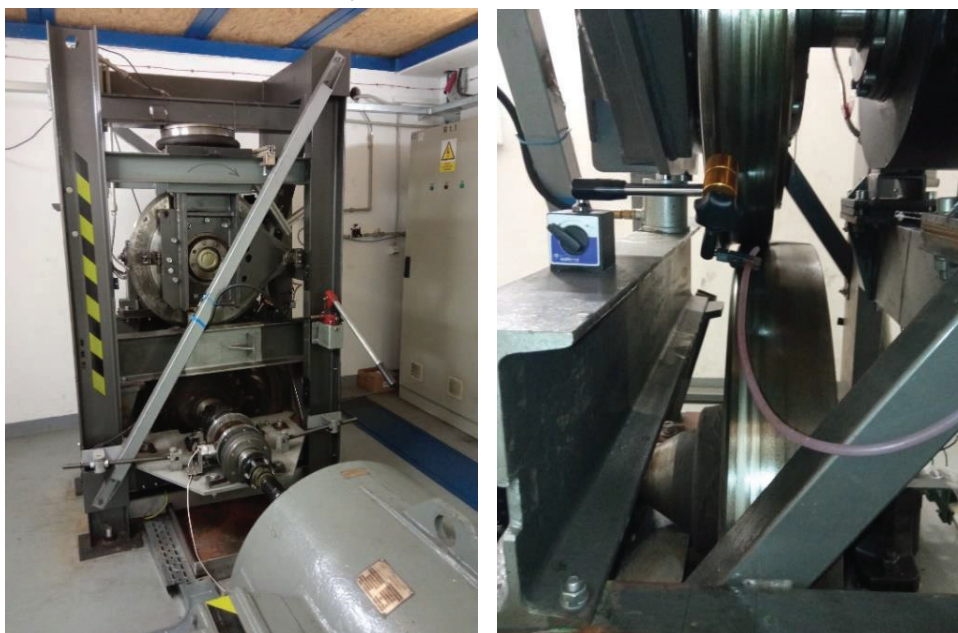
Obr. 2 Zkušební stav tramvajového kola a rotující kolejnici
