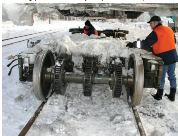
Fig. 3 Example of snow accumulating in bogie area Obr. 3 Príklad akumulácie snehu v oblasti podvozku
