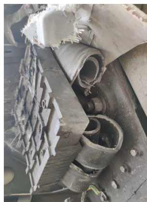
Obr. 5 Porovnání výsledků – plastické deformace – vyčerpání kapacity absorpčních členů
