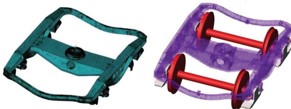
Obr. 3 Poddajný rám podvozku (vľavo), MBS model podvozku nákladného vagóna s poddajnými rámom (vpravo)
