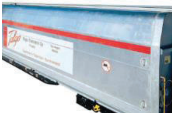
Obr. 14 Rychlý nákladní plošinový vůz s kapsou/košem má odklopný kryt a vlastní elektrický pohon a pojme dva 40' nebo čtyři 20' námořní kontejnery či automobilový návěs.
