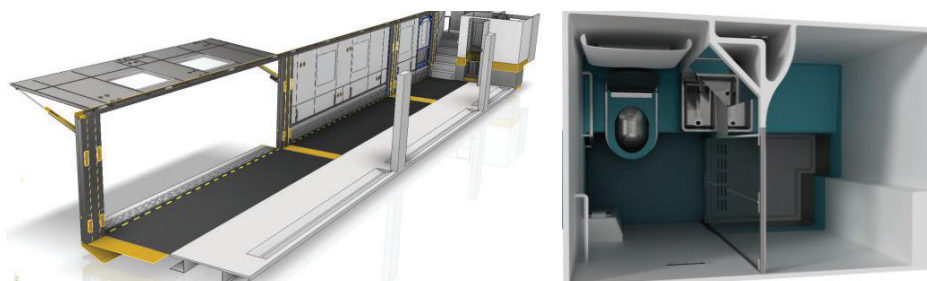
Obr. 9 Spodn ı patro  elezniřn ıho vozu ComplexTrans je opatřeno z obou stran n kladov mi dveřmi pro n kl dku a vykl dku vozidel a dv ma hygienick mi kouty s WC, umyvadlem a sprchov m koutem.
