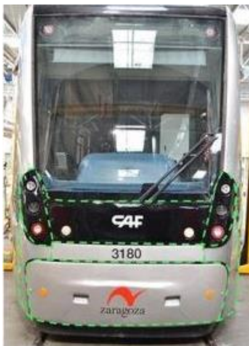
Obr. 7 Příklad tištěných komponent na čele tramvaje Urbos [1]
