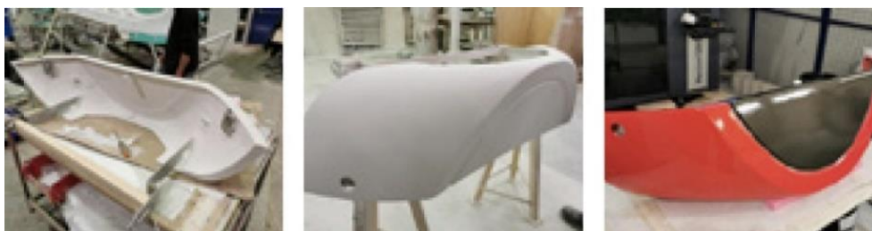
Obr. 8 Příklad čelních krytů tramvají Citadis [2]
