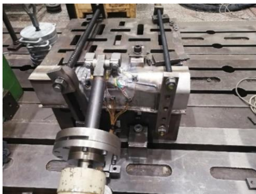
Obr. 5 Statick  a dynamick  testov n  sestavy konzoly tlumi e [3]
