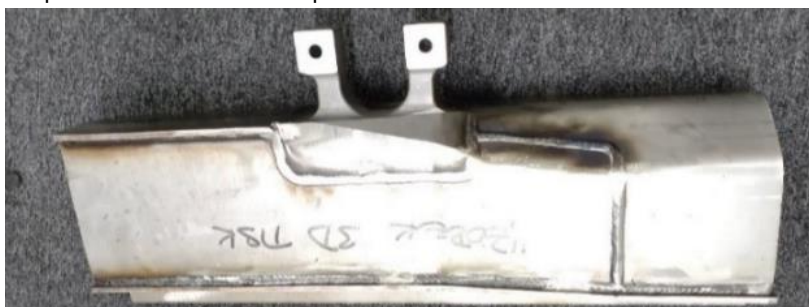
Obr. 4 Kompletn  sestava z stavby pro testov n  konzoly tlumi e [3]
