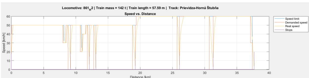
Obr. 13. Grafické zobrazenie priebehu rýchlosti pri simuláčnej jazde motorovej jednotky 861 s vodíkovým palivovým článkom na trati Prievidza - Horná Štubňa
