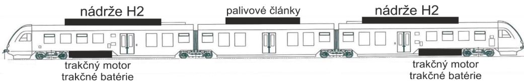
Obr. 12. Porovnanie rozloženia komponentov jednotlivých typov pohonu
