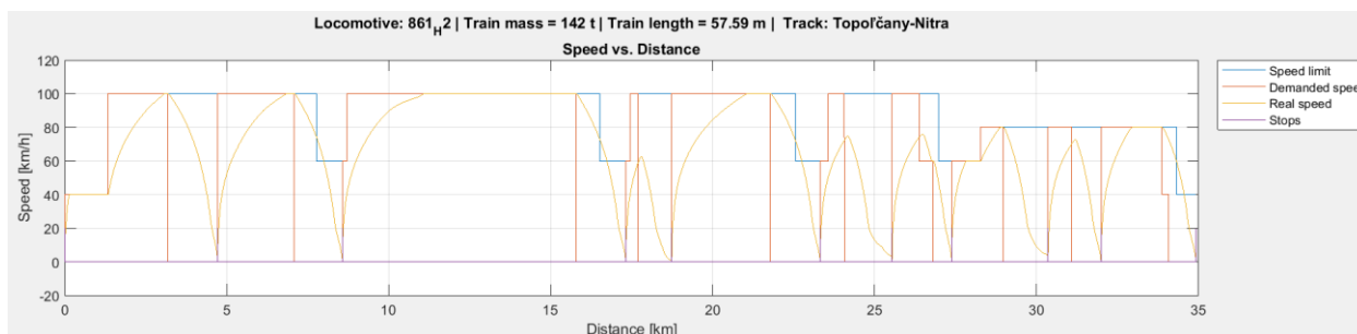
Obr. 16. Grafické zobrazenie priebehu rýchlosti pri simulačnej jazde motorovej jednotky 861 s vodíkovým palivovým článkom na trati Topoľčany - Nitra
