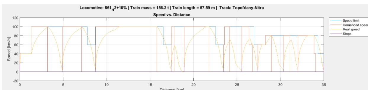
Obr. 18. Grafické zobrazenie priebehu rýchlosti pri simulačnej jazde motorovej jednotky 861 vodíkovým palivovým článkom na trati Topoľčany - Nitra , pri hmotnostnom náraste 10 %
