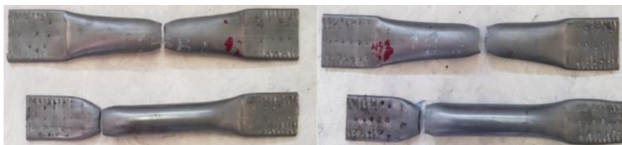
Obr. 9. Skúšobné vzorky po roztrhnutí Ø14 a Ø12
