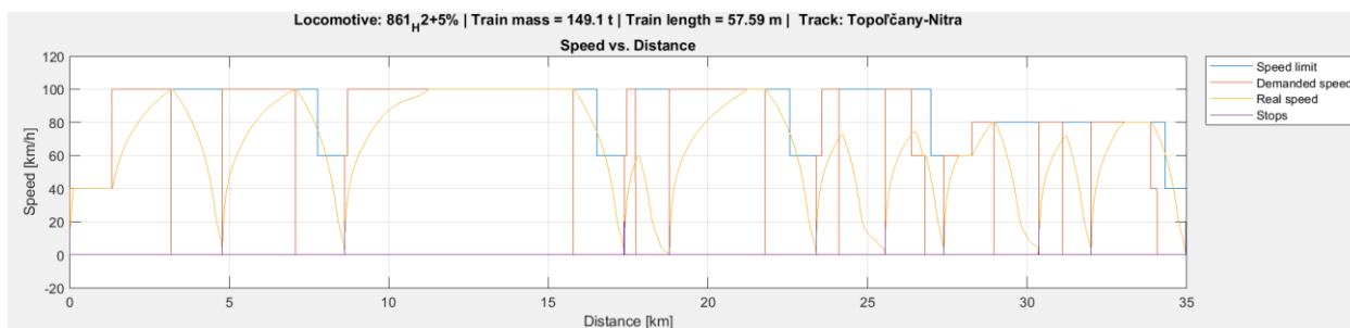
Obr. 17. Grafické zobrazenie priebehu rýchlosti pri simulačnej jazde motorovej jednotky 861 s vodíkovým palivovým článkom na trati Topoľčany - Nitra , pri hmotnostnom náraste 5 %
