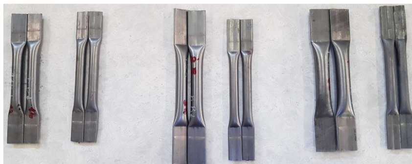
Obr. 8. Skúšobné vzorky pred a po ťahaní-vľavo Ø14 na Ø12 v strede Ø16 na Ø12 vpravo Ø18 na Ø12
