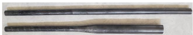
Obr. 5. Spodná rúra pred ťahaním \varnothing 18 a), vrchná rúra po ťahaní \varnothing 12 b)
