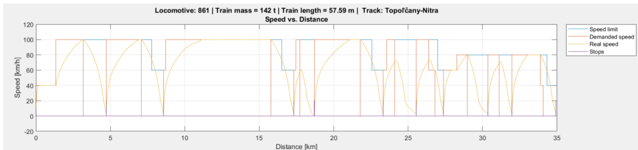
Obr. 8. Grafické zobrazenie priebehu rýchlosti pri simulačnej jazde motorovej jednotky 861 s dieselovým pohonom na trati Topoľčany - Nitra
