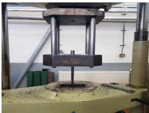
Obr. 2. Proces ťahania rúry na skúšobnom stroji EU 40 pomocou prípravku
