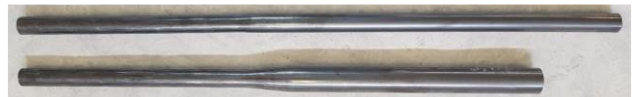
Obr. 4. Spodná rúra pred ťahaním \varnothing 16 a), vrchná rúra po ťahaní \varnothing 12 b)
