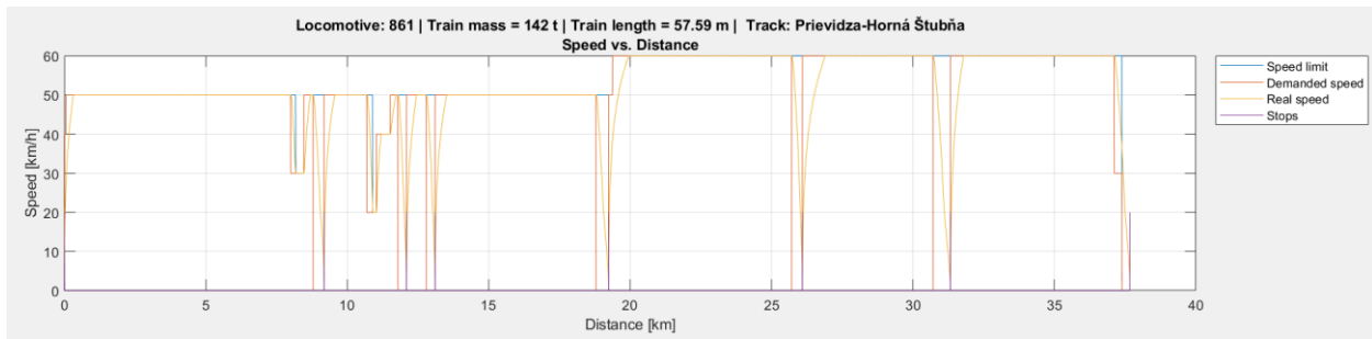
Obr. 5. Grafické zobrazenie priebehu rýchlosti pri simulačnej jazde motorovej jednotky 861 s dieselovým pohonom na trati Prievdza - Horná Štubňa
