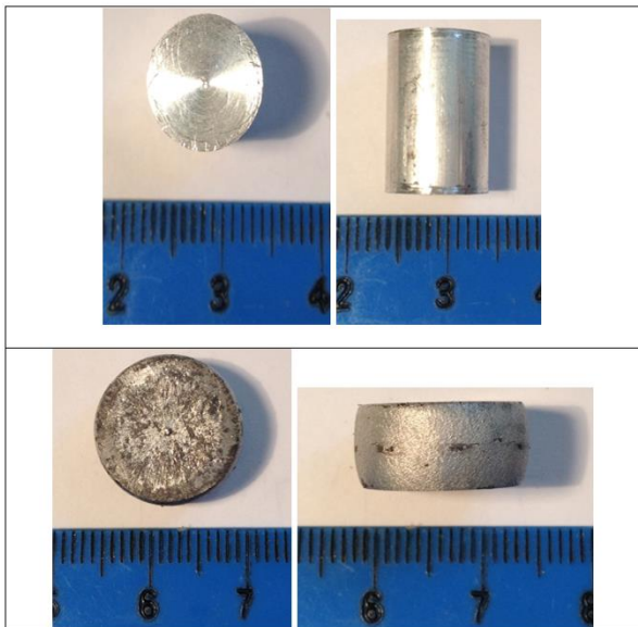
Obr. 4. Geometria skúšobných vzoriek pred a po skúške tlakom
