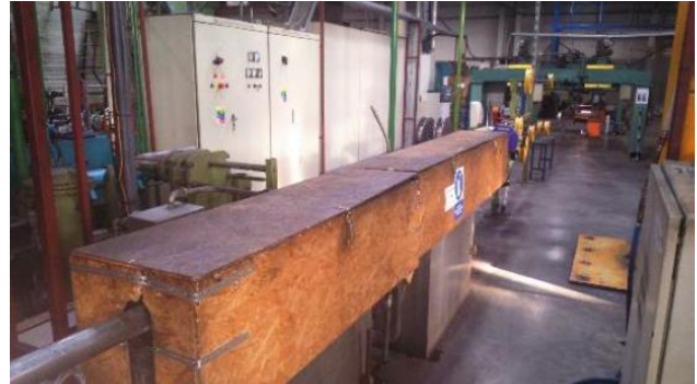
Obr. 6. Chladenie drôtu po pretlačovaní
