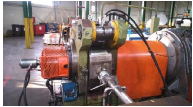
Obr. 5. Výstup drôtov z pretlačovacej hlavy a začiatok chladenia
