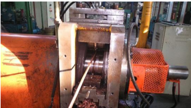
Obr. 3. Vstup materiálu (polotovaru) do stroja medzi valce na pretlačovanie
