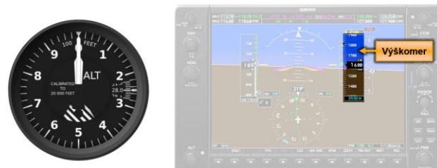
Obrázok 27: Vizualizácia informácií na analógovom a digitálnom výškomere [26] [27]
