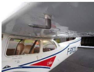
Obrázok 2: Pitot-statická trubica na letúne Cessna C172F Skyhawk [5]
