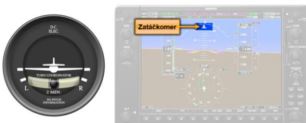
Obrázok 33: Vizualizácia informácií na analógovom a digitálnom smerovom zotrvačníku [26] [27]
