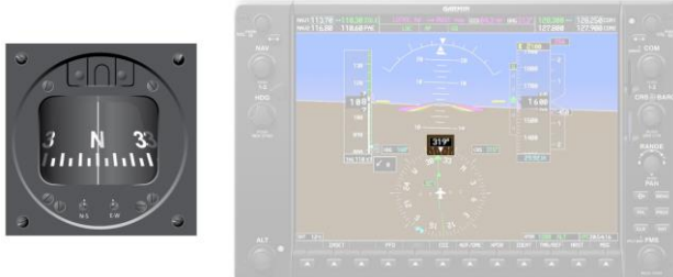
Obrázok 37: Vizualizácia informácií na analógovom a digitálnom magnetickom kompase [3] [27]
