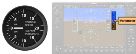
Obrázok 30: Vizualizácia informácií na analógovom a digitálnom variometre [26] [27]
