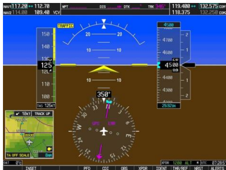
Obrázok 13: Primárny letový displej (PFD) Garmin G1000 [18]
