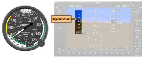
Obrázok 28: Vizualizácia informácií na analógovom a digitálnom rýchlomere [26] [27]
