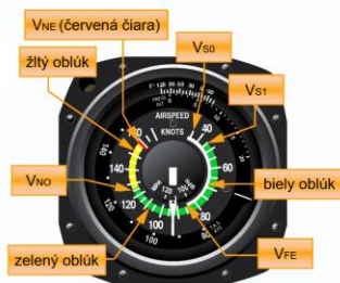
Obrázok 29: Štandardné farebné odlišovacie značky na rýchlo mere [3]
