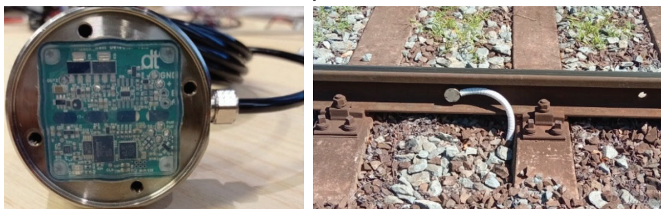
Obr. 4 Vyvinutý tenzometr pro použití za účelem diagnostiky oblasti srdcovky
