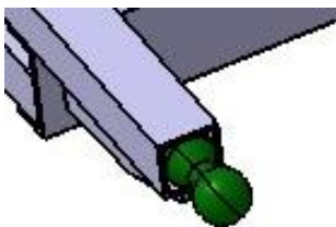
Obr. 3. Guľový čap pre pripevnenie sklápajúcej korby
