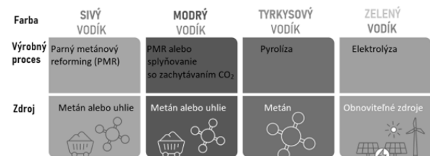
Obr. 2. Druhy vodíka podľa spôsobu výroby [5]
