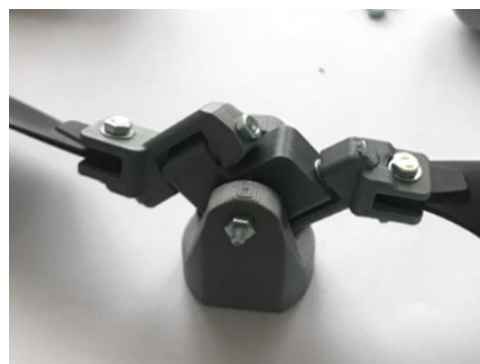
Obrázok 6. Dvojlistová rotorová hlava - vytlačený model
