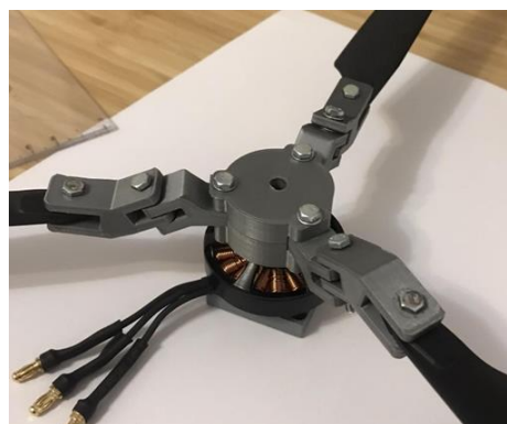
Obrázok 5. Trojlistová rotorová hlava - vytlačený model
