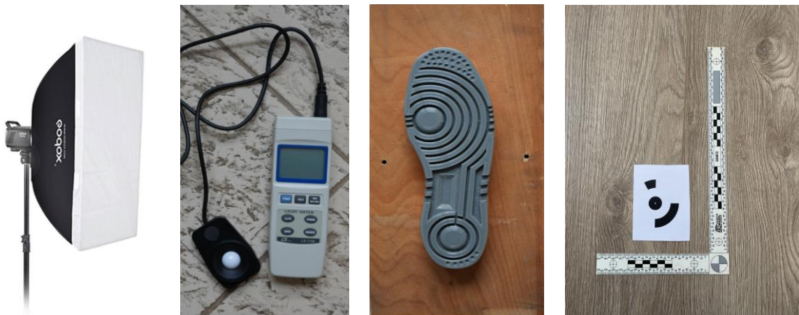
Obrázok 4 Zľava doprava: Svetlomet s LED svetlami zn. Godox Litemons LA200D, luxmeter zn. Voltcraft LX-1108, referenčná podrážka obuvi, kriminalistické pravítko a vlicovací terč (Kadnár, 2025)
