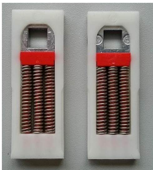
Obrázok 18: Pružiny v mechanizme otvárania dverí na palube lietadla. Zdroj: [ https://www.europeansprings.ie/springs-in-aircrafts/ ].
