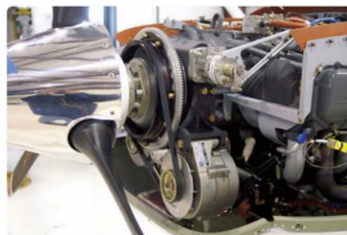
Obrázok 21: Remeňový prevod piestového motora na lietadle. Zdroj: [6].
